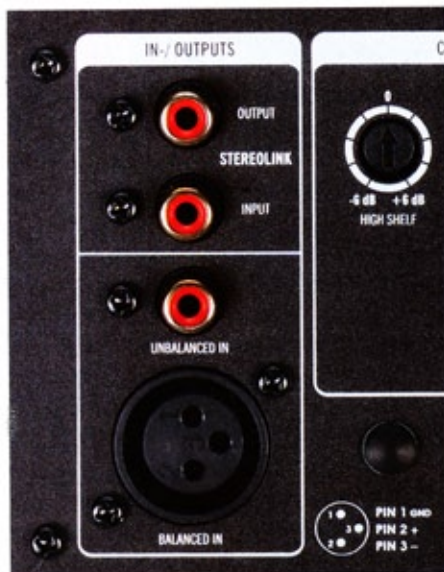
Via „Stereo Link“ (oben) lassen sich die beiden ADAM-Boxen koppeln und über einen Lautstärkesteller anpassen
