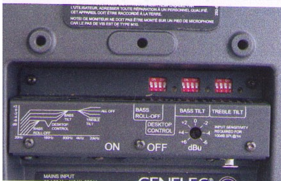
Die zwölf versenkten DIP-Schalter des Genelec 8040A erlauben umfangreiche Klang-Einstellungen.
