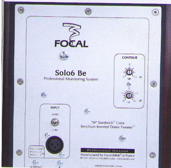
Der Focal Solo6 Be hat anstelle eines Lautstärkereglers lediglich einen Wahlschalter für zwei Eingangsempfindlichkeiten.
