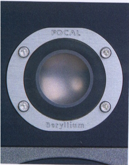
Der Hochtöner des Focal Solo6 Be ist aus dem seltenen Leichtmetall Beryllium, außerdem ist die Kalotte invertiert. Beides ist sehr aufwändig und kostenintensiv bei der Fertigung.
