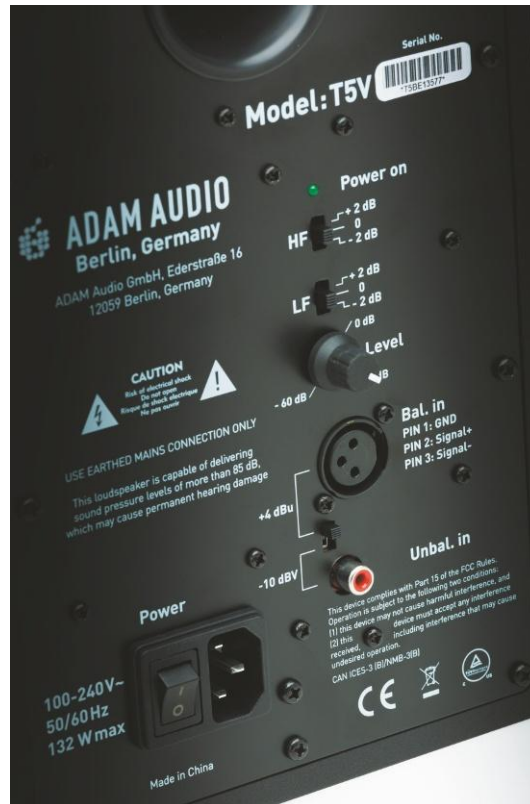
Signale gelangen per XLR- oder Cinchbuchse in die T5V. Bässe und Höhen lassen sich zur Ortsanpassung per HF- und LF-Schalter um je \pm 2 dB leicht korrigieren.
