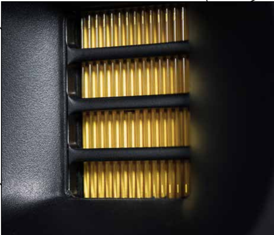
Der U-ART 1,9" Accelerated Ribbon Tweeter mit HPS-Waveguide leistet hervorragende Arbeit und trägt viel zum wahrhaft dreidimensionalen Klang der Lautsprecher bei.
