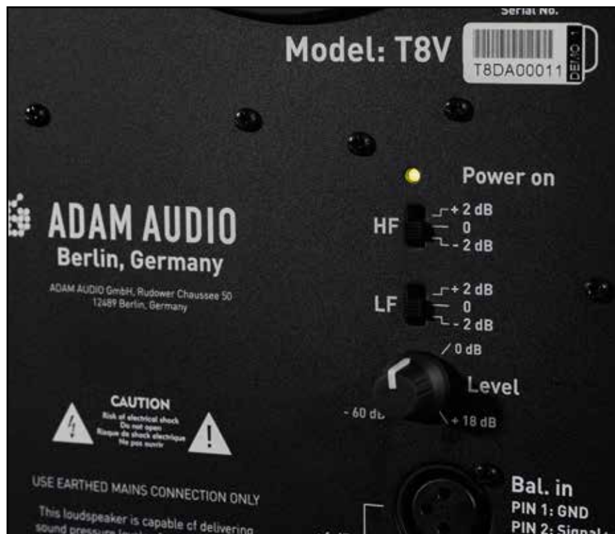
Auf der Rückseite finden wir die Schalter für die Regelung der hohen und tiefen Frequenzen, um die Boxen an ihren Standort anzupassen
